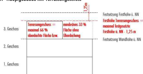
A Hauptgebäude mit Terrassengeschoss
